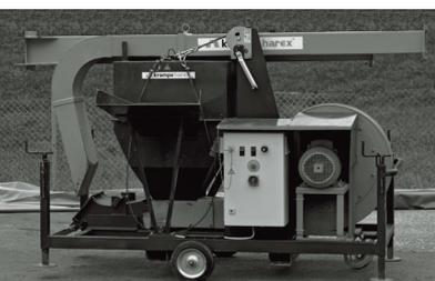
Mobiles Fasereinblasgerät KH 300 nicht auf Anhänger montiert
