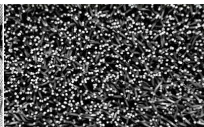
Geringerer Platzbedarf durch magnetische Ausrichtung der Fasern
