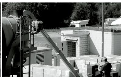
Ortsunabhängiges Einblasen der Fasern direkt in den Fahrmischer
